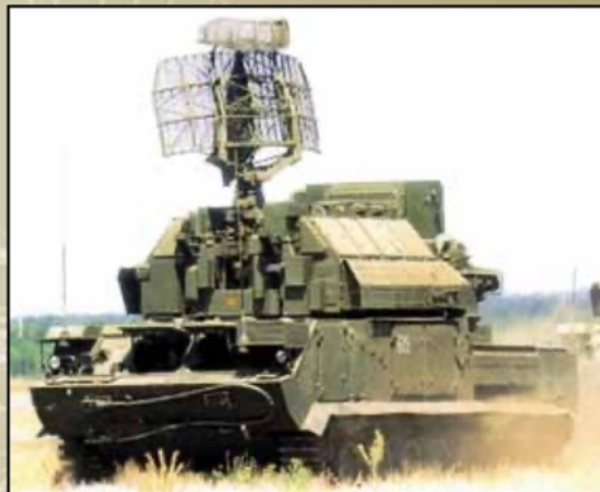
▲ Deze klassiek ogende inklapbare radar is de zoekradar.
