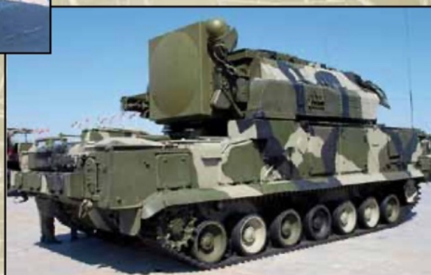
◀ Dit vierkante blok achterop het voertuig is de volgradar.
