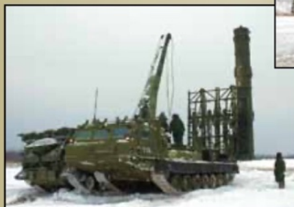
▲ Antey 2500 voertuigen. Voorop 9S32 Grill Pan. Daarachter de 9A82 TELAR (2 lanceerbuisen), de 9A83 TELAR (4 lanceerbuisen) en een 9A84 TEL (4 lanceerbuisen). Samen vervoeren ze hier maar één raketbuis die hieronder wordt overgeladen op het lanceer/transportvoertuig (9A84).
