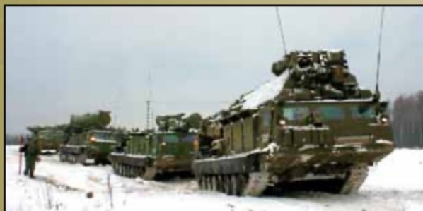
▲ Antey 2500 voertuigen. Voorop 9S32 Grill Pan. Daarachter de 9A82 TELAR (2 lanceerbuisen), de 9A83 TELAR (4 lanceerbuisen) en een 9A84 TEL (4 lanceerbuisen). Samen vervoeren ze hier maar één raketbuis die hieronder wordt overgeladen op het lanceer/transportvoertuig (9A84).
