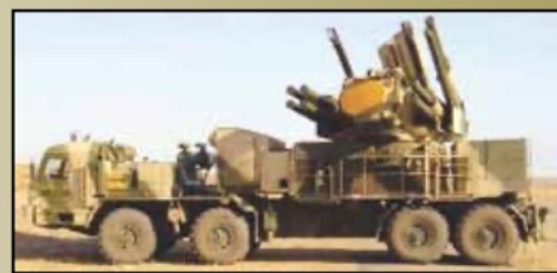
Een testopstelling op een BAZ-6909 onderstel
